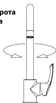
Аэратор (регулятор расхода воды) позволяет смесителю «выдавать» ровную водную струю без разбрзгивания.
